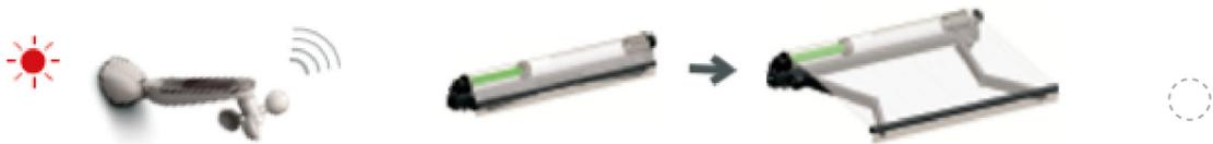
**Luminosidade** - Quando o sensor estiver configurado para 20 Klux e o nível de luz for maior o toldo abrirá.
